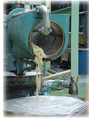
原料タンクに蓄えられていた麦を【連続洗穀機】で洗浄する行程です
