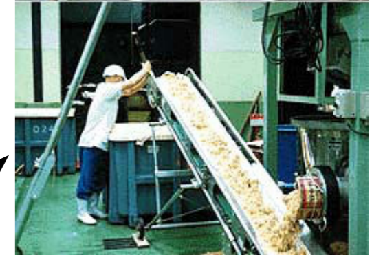
この行程で、すっかり麦麹に変身した原料麦と、ふっくら蒸し上がった大豆に、塩と種水を加えて混ぜ合わせます。まんべんなく混ざり合ったみそのもと、コンベアーで仕込容器に運ばれます
