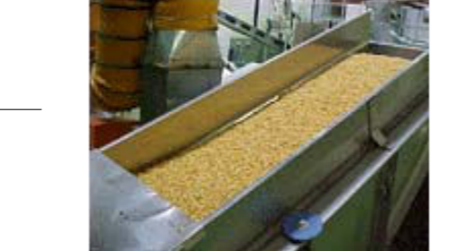
大豆は回転する大きな圧力釜で蒸煮します。蒸煮が終わった大豆は冷却しながら運ばれ、麦麹と混合して仕込みをする行程へと進みます。
