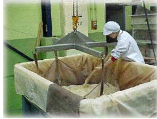
洗浄した原料の麦を水に漬けて柔らかくする(ふやかす)行程です。この後の行程に備えて、ネットとホイストがセットされたタンクで行なっています
