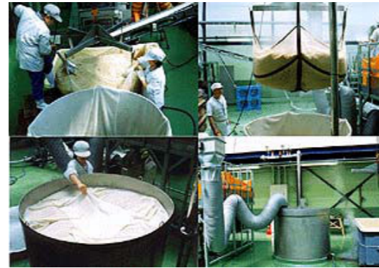
浸漬の終わった原料麦を甑(こしき)に移動し、布をかぶせてから甑で蒸し煮にします
