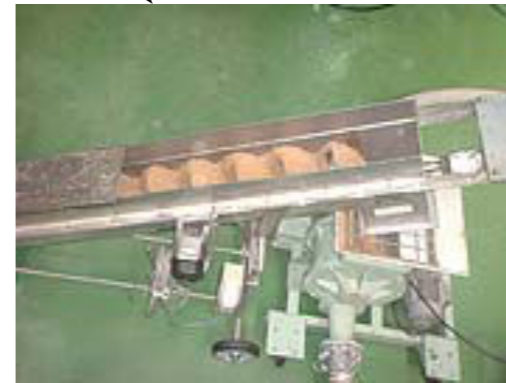
蒸煮の終わった麦をいったん冷まし、麹菌(こうじきん)と混合することによって、麦麹(むぎこうじ)の製造過程に入ります
