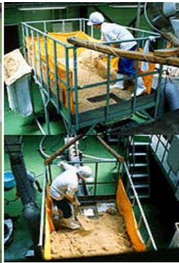
蒸煮の終わった麦をいったん冷まし、麹菌(こうじきん)と混合することによって、麦麹(むぎこうじ)の製造過程に入ります
